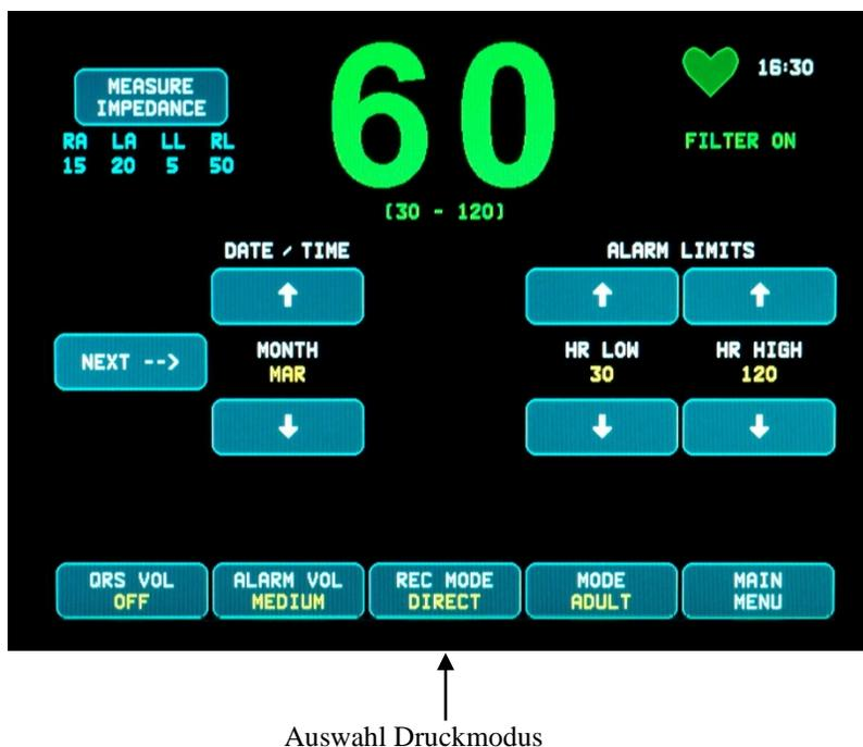
**Alle Druckmodi** - Um zu drucken, drücken Sie die Taste [PRINT] (Drucken) im Hauptmenü. Drücken Sie erneut die Taste [PRINT], um das Drucken zu beenden.
